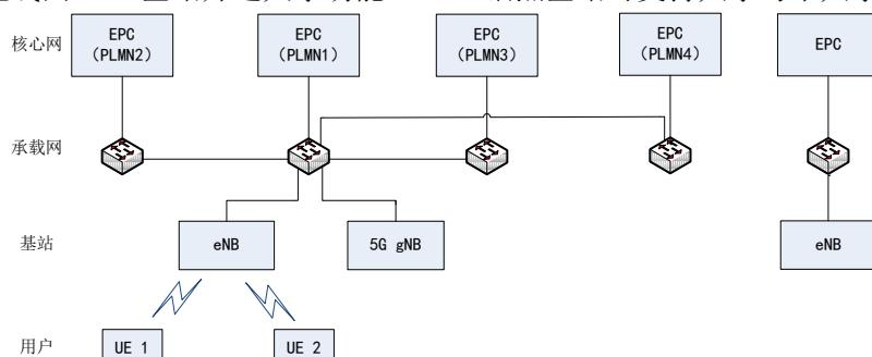
图 2 5G NSA 接入网共享测试组网示意
