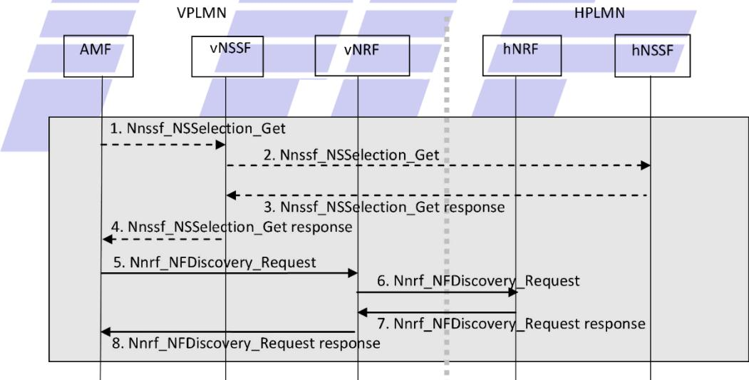
图 B. 6 有 NSSF 参与的 hSMF 选择流程
