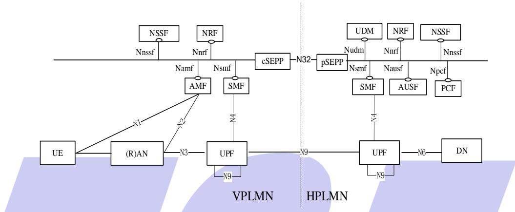
图 3 5G SA 核心网漫游组网架构图
