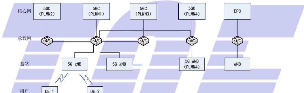
图 1 5G SA 接入网共享测试组网示意
