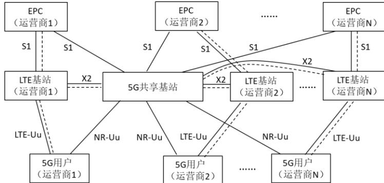
注：图中实线表示用户面，虚线表示信令面。
