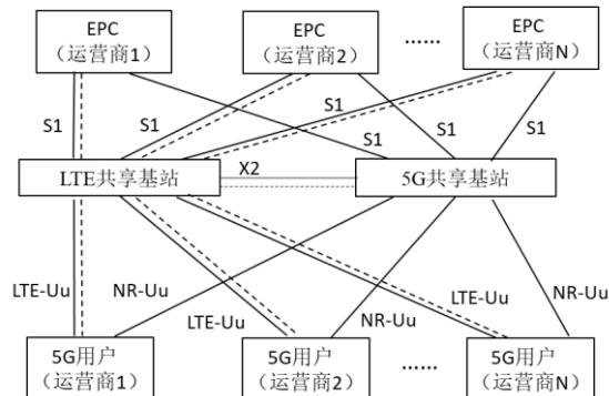
注：图中实线表示用户面，虚线表示信令面。
