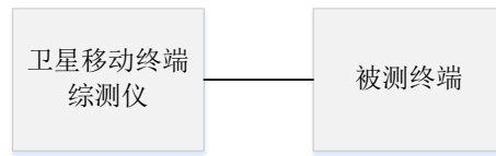
图7 矢量幅度误差测试连接图
