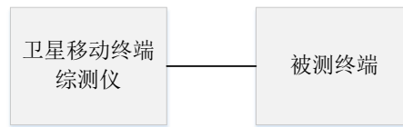
图2 矢量幅度误差测试连接图
