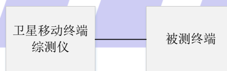
图3 矢量幅度误差测试连接图
